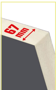
Verzugsarmes und wärmegeädmmtes Stahltürblatt, 67 mm stark, mit PU-Hartschaum gefüllt
